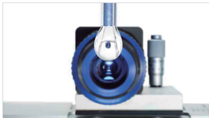
Vista de uma gota pendente para medir a tensão superficial
