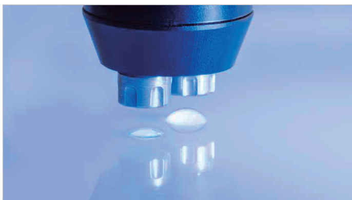
Medição SFE com duas gotas usando a Liquid Needle
